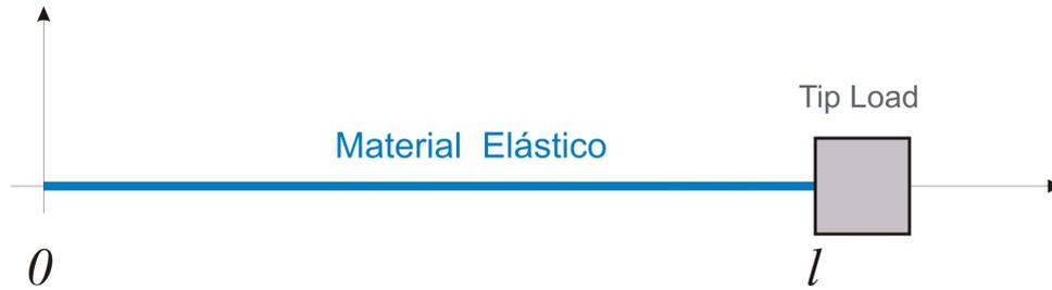
Figura 2.2: Corda híbrida elástica com tip load.
