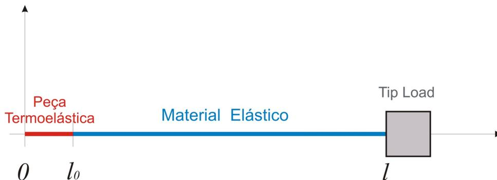
Figura 2.1: Corda híbrida composta de peça termoelástica e tip load.
